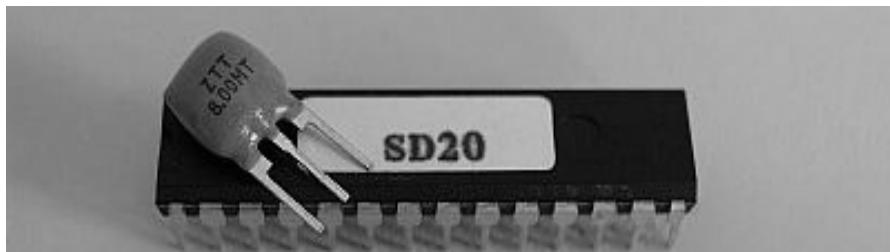
Der SD20 ist ein vorprogrammierter PIC16F872 und läuft mit einer Geschwindigkeit von 8MHz. Positions-Steuerbefehle für bis zu 20 Modellbau Servos werden über den I<sup>2</sup>C Bus an den Controller gesendet.
