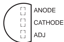
LM336-2.5, LM336B-2.5 . . . LP PACKAGE (TOP VIEW)
