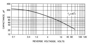
Fig. 4-TYPICAL JUNCTION CAPACITANCE
